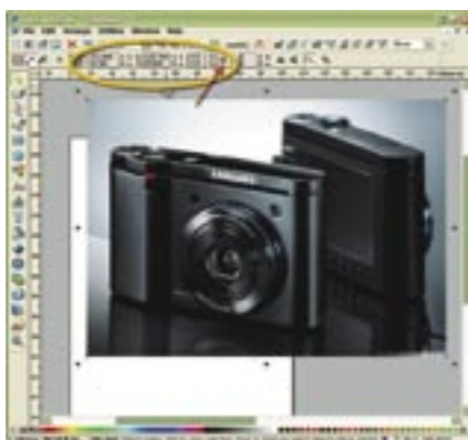
Pontosság: a számbeviteli mezőket a bittérképes objektumok pontos méretezéséhez és elhelyezéséhez használjuk. A „lakat” kikattintásával rögzíthetjük az oldalárányokat: nem torzul a kép
