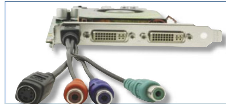
Modern megoldás: a komolyabb videokártyákon ma már elérhető a komponens kimenet
