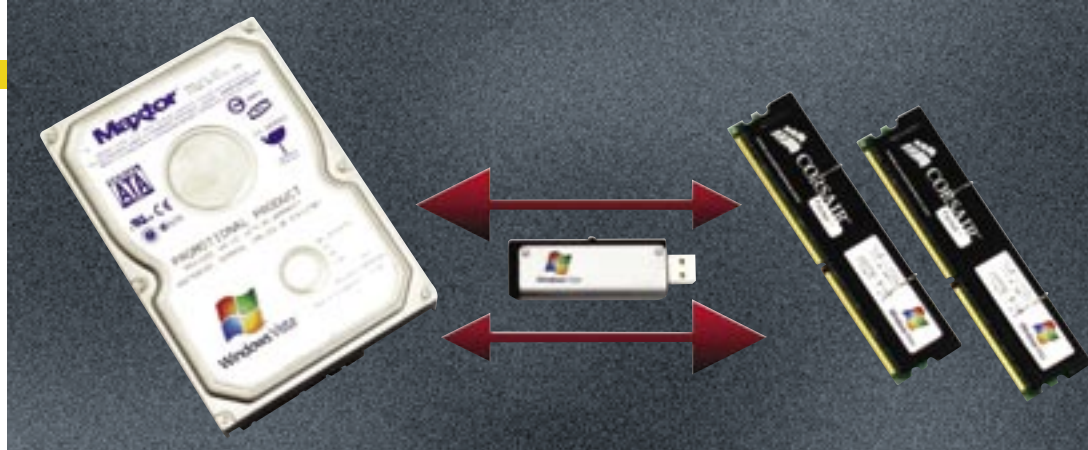
A VISTÁVAL KIBŐVÜL A TÁRHIERARCHIA: a HDD és a memória közt a Vista logós flashmemória a kapocs
