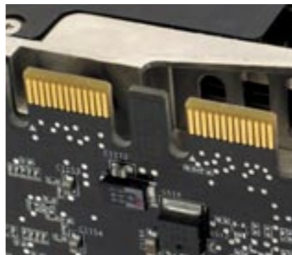
KÉT SLI CSATLAKOZÓ A GEFORCE 8-AS KÁRTYÁKON: rejtélyes tartalékok az SLI-ben
