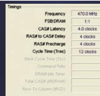
EKEGIG „HÚZOTT” MEMÓRIA: 940MHz-es sebességre már megfelelő a sáv szélesség
