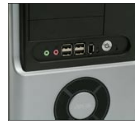
HASZNOS CSATLAKOZÓK AZ ALIEN GÉPÉN: a kettő helyett négy USB 2.0 hasznos bővítés, ám a Firewire nincsen bekötve az alaplapi vezérlő hiánya miatt
