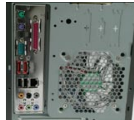
TEMÉRDEK CSATLAKOZÁS A HÁTLAGON: a többcsatornás hangkimenet és LAN mellett ma még ritkaság az eSATA, aminek a jövőben még nagy hasznát vehetjük
