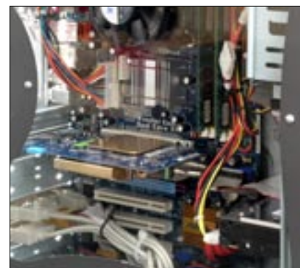
REND ÉS CSEND A VISION GÉPÉBEN: a passzív hűtésű VGA és chipkészlet mellett a gyári Intel CPU hűtőt alig fűti a Core 2 Duo
