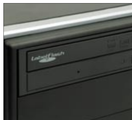
SZÍNEN PASSZOLÓ OPTIKAI MEGHAJTÓK: egyeduralgkódó a DVD-író, ráadásul szinte mindegyik modell képes a speciális lemezek feliratására is (Labelflash vagy LightScribe)
