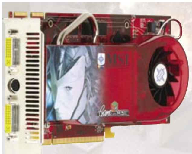
AZ MSI X1950PRÓA: kiváló, egyedi hűtés és jó körítés, ám vásárlásnál vigyázzunk, mert nem mindegyik változathoz jár a CrossFire összekapcsoló kábel
