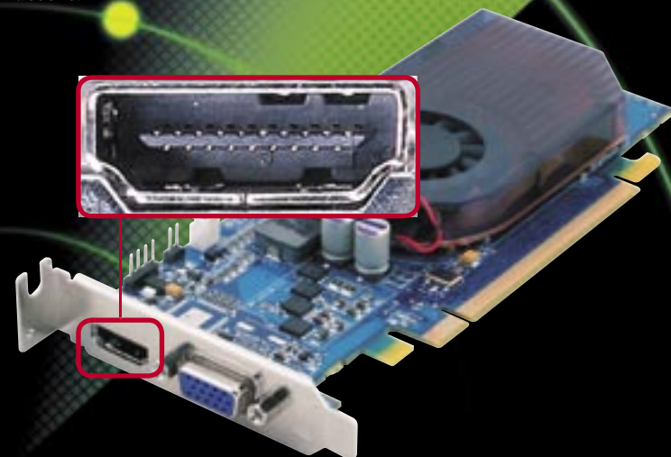
HDMI KIMENET Egyre több videokártyán találkozhatunk az új csatlakozással, amin másolásvédelemmel ellátva vezethetjük ki a nagyfelbontású videót és térbeli hangzást
