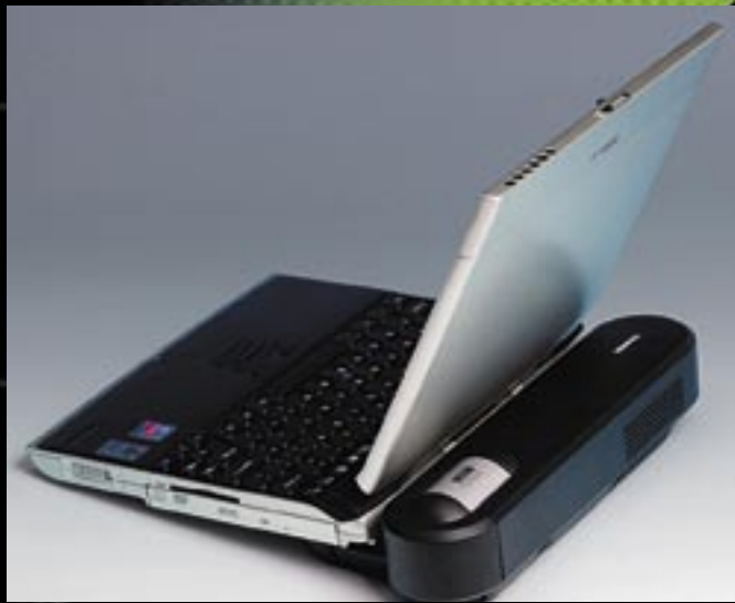
ENERGIAFORRÁS FÉNYES JÖVŐVEL Ez a 900 gramm súlyú üzemanyagcella egy Centrino-alapú noteszgépet akár 5 órán át is képes ellátni energiával mindössze 50 köbcentiméter metanolt használva
