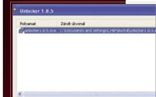
6 FELSZABADÍTÁS Az Unlocker azonosítja, és ha kell, le is állítja azokat a folyamatokat, amelyek egy fájlt használnak, és ezért zárolják azt
