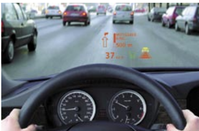
BMW HUD Egyes BMW modellekben már évek óta helyet kap az a technológia, mely a szélvédőre vetíti ki a navigációs jelzéseket
