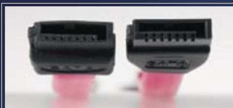
LEMEZKATASZTRÓFA Balra a tönkrement csatlakozó. A PC magas hőmérsékletétől elgörbült a műanyag borítás – a következmény: érintkezési problémák. Jobbra egy egészséges csatlakozó
