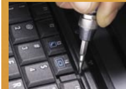
A BILLENTYŰZET LESZERELÉSE II Előfordul, hogy csak pár műanyag kapcsoló kell kioldanunk a gombok eltávolításához
