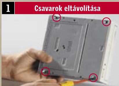
1 Csavarok eltávolítása Csavarjuk ki a CD- vagy DVD-meghajtó alsó borítólappját rögzítő négy csavart a keresztélű csavarhúzóval.
