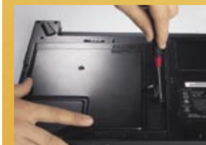
AZ ALSÓ BURKOLAT ELTÁVOLÍTÁSA A memóriamodult legtöbbször az alsó burkolaton található fedél alatt találjuk
