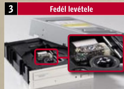
3 Fedél levétele A lejártszó megfordítása és a borítófédél levétele után a fiók alatt felismerjük a lézerezés üveglencsését.
