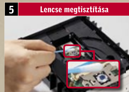
5 Lencse megtisztítása Tisztítsuk meg az üveglencsét óvatosan, de alaposan. Ha a szennyeződések eltűnnek, megszűnnek az olvasási hibák is.
