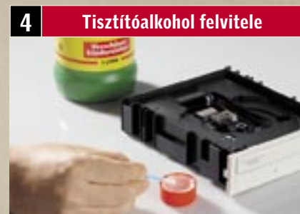
4 Tisztítóalkohol felvitele Nedvesítsük be a pálcika végén a vattát az alkohollal vagy spirítusszal – de csak annyira, hogy véletlenül se csöpögjön belőle!
