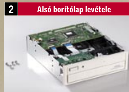
2 Alsó borítólapp levétele Az alsó borítólapp eltávolítása után előbukkan az optikai meghajtó elektronikája, és a borítófédél is kioldódik.
