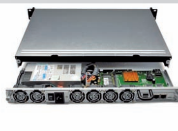
A szekrénybe építhető ReadyNAS 1100 szép előlapjánál fontosabb az egyben cserélhető vezérlés ( X-Change S10 )
