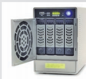
A négy merevlemezű ReadyNAS NV+ rendszerhez egyesével adhatjuk hozzá a meghajtókat, a RAID biztonság dinamikusan bővíti
