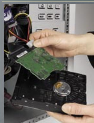
5 ÁRAMKÖR CSERE Az indítási folyamat kikerülésére a vezérlést a már működésbe helyezett gépben cseréljük ki
