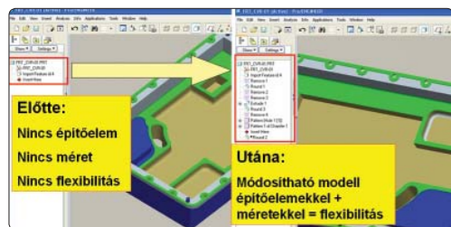
Importált modell parametrizálása építőelem-felismeréssel
