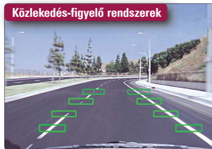
Közlekedés-figyelő rendszerek A sávelhagyás-jelző (LDW-Lane Departure Warning) felismeri az útburkolati jeleket és az útpadkát
