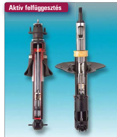
A Delphi MagneRide-ja bármelyik új autóba beépíthető
