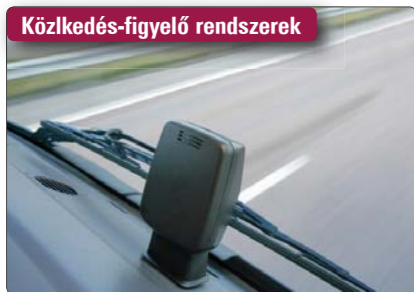
Közlekedés-figyelő rendszerek A Scania sávelhagyás-jelzője egyetlen, egyszerű kamerát használ – egy megfelelően izmos számítógéppel megtámogatva
