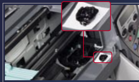
RÉGI FESTÉK Ez a fekete tintából odaszáradt csomó blokkolta a PhotoSmart nyomtató tisztító mechanikáját
