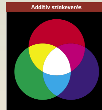
TÖBB FÉNY Az összeadó keverésnél a különböző hullámhosszúságú fénysugarak „összeadódnak”, így jön létre a fehér szín
