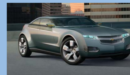
Chevrolet Volt: az első nagyszériás elektromos autónak 2010 végén kell az USA-n keresztülgurulnia, és nem sokkal később Európán is. A hatótávolság növelésére benzin üzemű áramgenerátorral lesz felszerelve. Info: www.chevrolet.com
