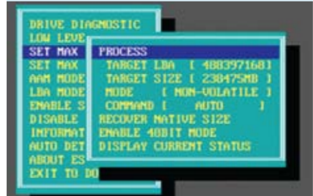
Alacsony szintű merevlemez-kezelés Az ES-Tool a Samsung merevlemezek működési paramétereit tudja megváltoztatni
