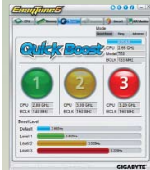
Gigabyte Quickboost A háromféle, fix tuning opció hatékony, de finomhangolásból nincsen automatikus. A manuális mód kifinomult, minden BIOS-ban megtalálható értéket direktben változtathatunk
