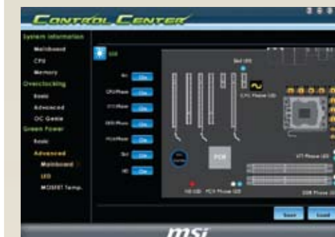
MSI Control Center Windows alól is tuningolhatjuk rendszerünket, előtte azonban BIOS-ból le kell tiltanunk az O.C. Genie-t. A programmal figyelhetjük a DrMOS-ok hőmérsékletét és működését is
