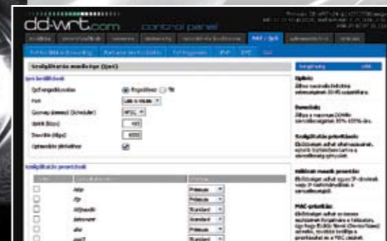
A DD-WRT szinte mindent tud Az egyedi firmware QoS-ének működését a LAN és WLAN portokra engedélyezzük
