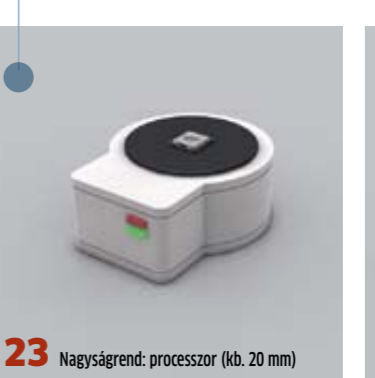
23 Nagyságrend: processzor (kb. 20 mm) Teljesítménybesorolás Ennél a végso tesztnél a processzorok teljesítményképességét vizsgálják, például a hőleadás és maximális órajel-frekvencia szempontjából. Az eredményeknek megfelelően osztályozzák és feliratozzák a processzorokat (lézergravírozással).
