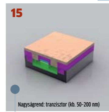
15 Nagyságrend: tranzisztor (kb. 50-200 nm) Galvanizálás II. Az ostyafelületen a galvanizálás eredményeképpen egy lehetővé válik a rézréteg képződik.
