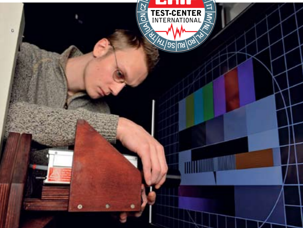
Pixelpontos megméréstetés Tesztlaborunk munkatársa különféle ábrákkal, professzionális mérőfelszereléssel, és különleges lencsékkel teszteli a képmínőség fő összetevőit
