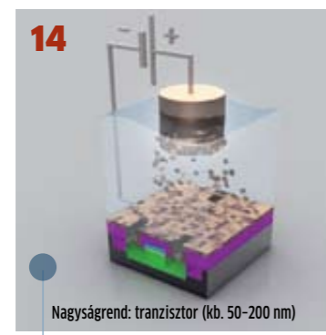
14 Nagyságrend: tranzisztor (kb. 50-200 nm) Galvanizálás I. Galvanizálásnál az ostyákat réz-szulfát oldatba mártják. A rézionok a pozitív töltésű anódról (fent) az ostyára (lent) vándorolnak, amely katódként működik. A rézionok lerakódnak a tranzisztoron.
