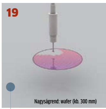
19 Nagyságrend: wafer (kb. 300 mm) Selejtezés Az ostyát szilíciumchipekre vágják szét. Csak azok a lapkák juthatnak tovább a következő gyártási folyamatba, amelyek minden teszten megfeleltek.
