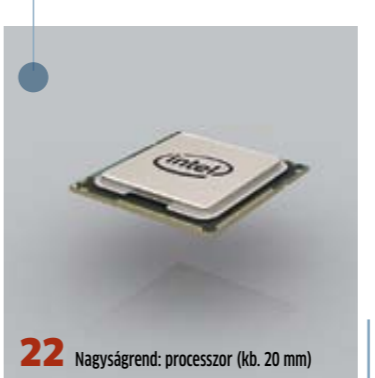
22 Nagyságrend: processzor (kb. 20 mm) Kész processzor Így néz ki a kész processzor. A modern CPU-k a világ egyik legbonyolultabb és legigényesebb gyártási folyamata során létrejövő termékek: a chip gyártása például mindig a legmagasabb szintű tisztaságban folyik – ezek 10 000-szer tisztábbak, mint egy műtő.
