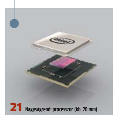
21 Nagyságrend: processzor (kb. 20 mm) Tokozás Egy CPU készre gyártásához a chipet összeillesztik a hordozó hátlappal (zöld) és a hőelosztó „sapkával” (ezüst). A hordozólap szolgál elektromos csatlófelületként a rendszer többi részéhez, a hőelosztó segít elvezetni a működési hőt.
