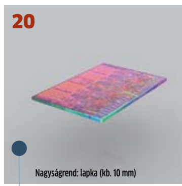
20 Nagyságrend: lapka (kb. 10 mm) Szilíciumchip A képen egy Core i7 Intel processzor chip látható, amelyet 30 cm-es ostyából vágtak ki.
