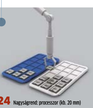
24 Nagyságrend: processzor (kb. 20 mm) Kiszállítás Végül a CPU-kat szétválogatják, és szállító tálcákra helyezik a PC- és notebook-gyártók számára – vagy kereskedelmi csomagolásban szállítják ki a szaktalpakba.
