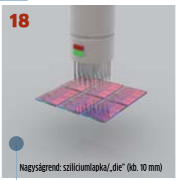
18 Nagyságrend: szilíciumlapka/„die” (kb. 10 mm) Waferteszt A kész ostyának ezt a részét most funkcionális tesztnek vetik alá. Egy sor tesztlekérdésként küldenek minden egyes szilíciumchipnek, és ellenőrzik, hogy azok teljesen hibátlanul reagálnak-e.
