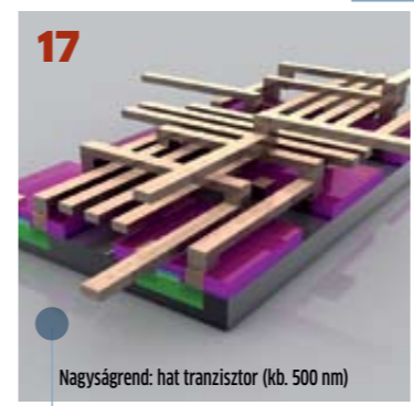
17 Nagyságrend: hat tranzisztor (kb. 500 nm) Fémrétegek A következőkben több fémréteget („layer”) hordanak fel, amelyek - a vezetékhez hasonlóan - a tranzisztorokat kötik össze egymással. Hogy ezeknek a csatlakozásoknak hogyan és hova kell kerülniük, azt a processzor mikroarchitektúrája határozza meg.
