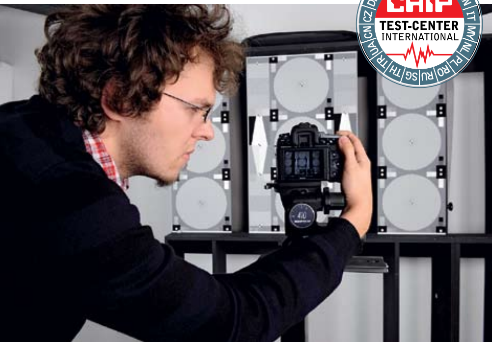
Dívatfotók Tesztlaboros kollégánk éppen a digitális tükörreflexes fényképezőgépek képességeit vizsgálja tesztábrák segítségével
