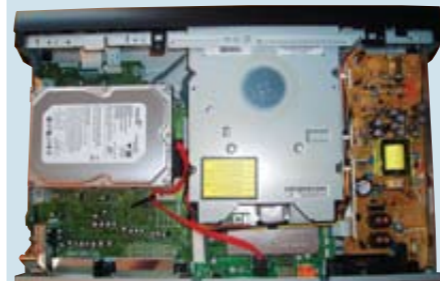
Szerencsés kevesek A Sony RDR-HXD1070B esetében a nagyobb merevlemez beépítését már megoldották, de csak speciális eszközökkel
