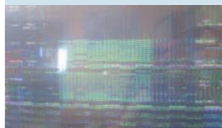
Memóriahiba Ha a képi elemek ehhez hasonlóan, blokkosan esnek szét, a memória a hibás. Ha a GPU, a PC lefagy
