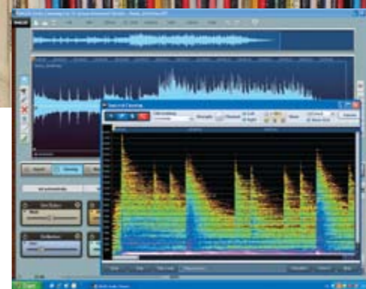
Mosógép A Magix-féle Audio Cleaning Lab a spektrum-analizátor segítségével próbálja meg kiszűrni az interferenciát
