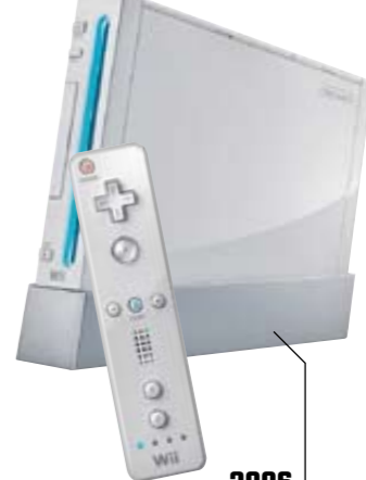
2006 Wii Remote Control A Wii vezeték nélküli kontrollere a játékosok mozgását érzékeli és továbbítja a szoftver felé
