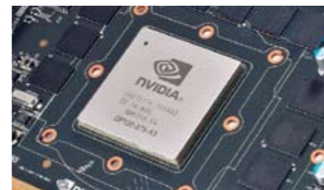
Óriás chip A GTX 480-on dolgozó NVIDIA GF100 GPU méretileg és fogyasztásban is hatalmas
