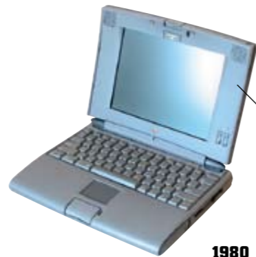
1980 Tapipad Egy speciális érzékelővel ellátott felület ujjunk mozgását a mutató mozgásává alakítja
