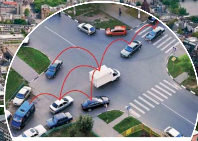
KAPCSOLAT MÁS JÁRMŰVEKKEL Ha egy, a forgalmat érintő baleset következik be, vagy kialakul egy dugó, a járművek a WAVE kapcsolatot használva értesítik egymást, a mobil hálózaton keresztül pedig a központot. Így a mentőcsapatok kikerülnek a dugókat, és hamarabb odaérnek a helyszínre
