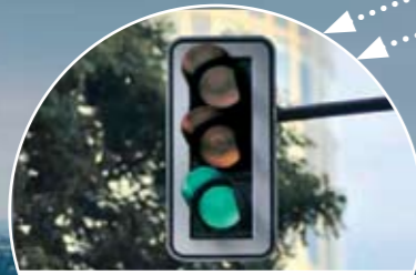
JELZŐLÁMPA Állapotait a kereszteződésben álló vagy oda érkező járművek számától függően változtatja - ez a műszerfalon is látható lesz
