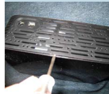
A csavar nélküli ház hátránya A fém csavarhúzó nyoma könnyen megmaradhat a műanyagban (kép: www.instructables.com )
