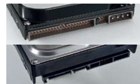
Merevlemez Figyeljünk, milyen külső HDD házat választunk: a felső az IDE (PATA), az alsó a SATA
