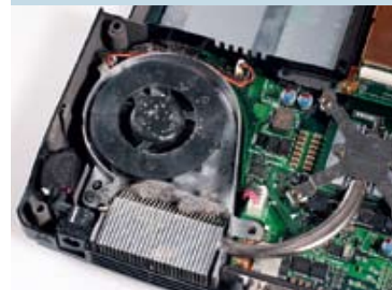
Szigetelőgyapot Ha a szellőzőnyílás elé belül filccel sűrűsödött por rakódik, garantáltan megreked a meleg
