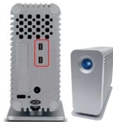
Leegyszerűsítve A LaCie hipergyors SSD-RAID külső egységének nem elég az USB 3.0, ezért már a Thunderbolt csatlakozást használja
