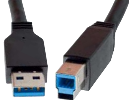
Egy új USB 3.0 csatlakozó A bal oldalon látható (A) csatlakozó kompatibilis a régebbi vezérlőkkel, de a jobb oldali nagyobb elődjénél
