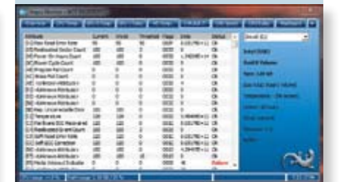
Media Wearout Indicator Az SSD-k S.M.A.R.T. adatai közötti érték a cellák fáradását, a meghajtó élettartamát hivatott jelezni
