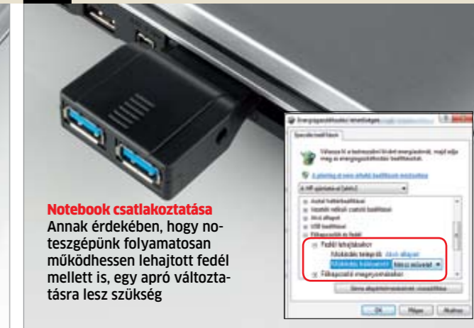
Gyors csatlakozás Ha noteszgépünk rendelkezik ExpressCard foglalattal, akkor használhatunk egy USB 3.0-s bővítőkártyát
