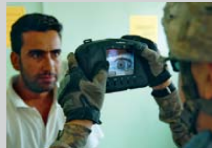
Retinakép Ennél az eljárásnál a szemfenéken található erek mintázata jelenti az azonosításhoz használt tulajdonságot
