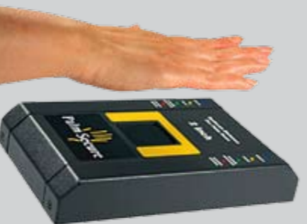
Vénák hálózata Ez a készülék infravörös fény segítségével rögzíti ereink alakját és vastagságát
