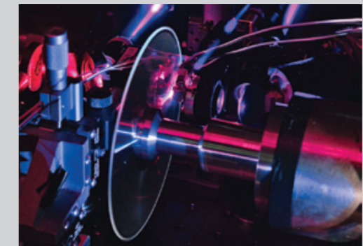
A GE átlátszó holografikus lemeze rétegek tucatjaiban tárolja az adatokat
