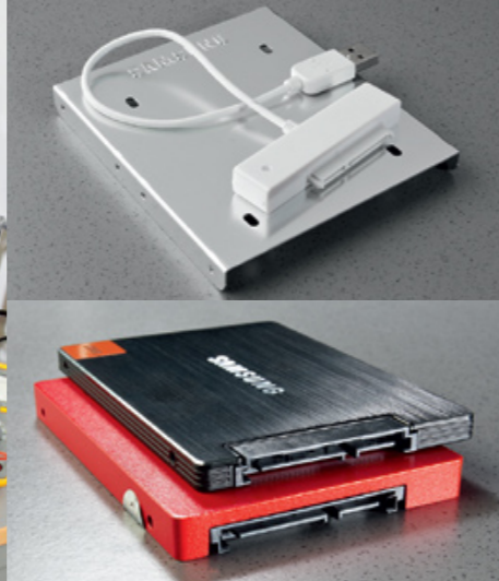
Csomagajánlat: néhány ezer forintos extraköltségért SATA-USB átalakítót és 3,5 colos beépítőkeretet kapunk
