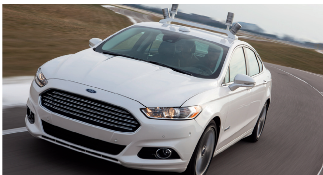
A Ford a Fusion Hybrid modelljével teszteli az önjáró vezetést, amely a tetőn elhelyezett lézerral vizsgálja a környezetét
