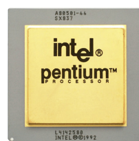
1993 Intel Pentium P5 Az első, párhuzamos parancsfeldolgozásra képes (szuperskalár) CPU és a Pentium-korszak
