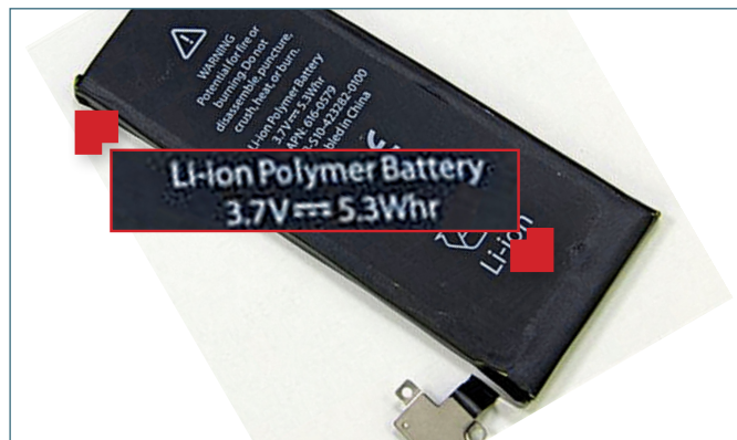
Kiszámolhatjuk egy mobil (iPhone 4S) akkumulátorának kapacitását is: 5,3 Wh/3,7 V = 1432 mAh. Méretéhez képest nagy kapacitású
