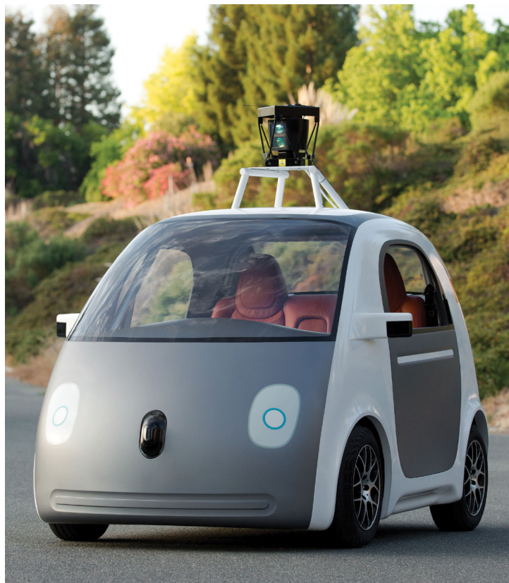
A Google saját prototípusa kormány, fék és gázpedál nélkül – a tetőre szerelt érzékelők belátják a teljes terepet
