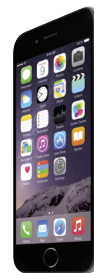
2014 iPhone 6 Az Apple telefonjában dolgozó A8 chip 89 mm 2 -es területén 2 milliárd tranzisztor van
