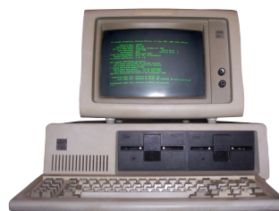
1981 IBM PC 5150 Az első „személyi számítógépben” az Intel 8088-as mikroprocesszora dolgozott
