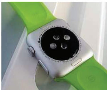
Az óra hátoldalán az optikai pulzsmérőt találjuk, amely infravörös fényvel működik
