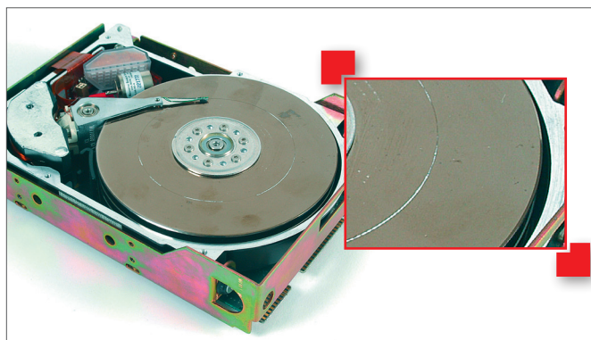
Egy tönkrement olvasófejű merevlemez fel kell nyitni, hogy az adatokat le lehessen olvasni a még sértetlen sávokról
