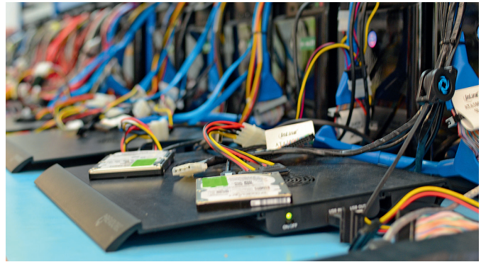
Az Ontrack másolóállomásai egyszerre több tucat meghajtó lemezképet képesek elkészíteni
