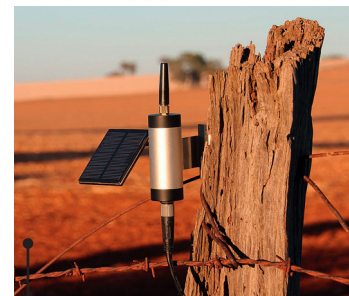
A gateway alig nagyobb egy mai okostelefonnál, és hosszú ideig képes karbantartás nélkül is megbízhatóan működni
