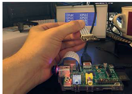
A kamerát a Raspberry Pi panelja felé irányítva könnyen megállapíthatjuk, megfelelő-e a fókusz távolság
