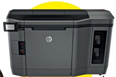
2016 Meghódítja a világot A technológia kiforrott, és egyre izgalmasabb, a HP Voxel nyomtatója (kb. 155 000 dollár) egyszerre több színnel és anyaggal is képes dolgozni.
