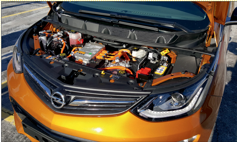
Belső égésű motor nélkül is tele: az Ampera-e elektromos motorja nagyjából akkora, mint egy 5 literes söröshordó. A gépháztető alatt sok teljesítmény-elektronika, radiátor (az akkuhoz) és segédberendezések találhatók
