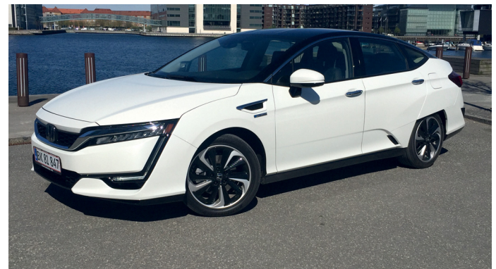
Úrhajó kereken: a Honda Clarity hidrogéntankol, üzemanyagcellával állít elő vele áramot, és mindennapi használatra alkalmas
