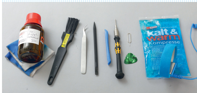
Egy mobiltelefon felnyitásához szükség lesz néhány szerszámra, elsősorban csavarhúzókra, feszítőkre és egy melegíthető hőpárnára
