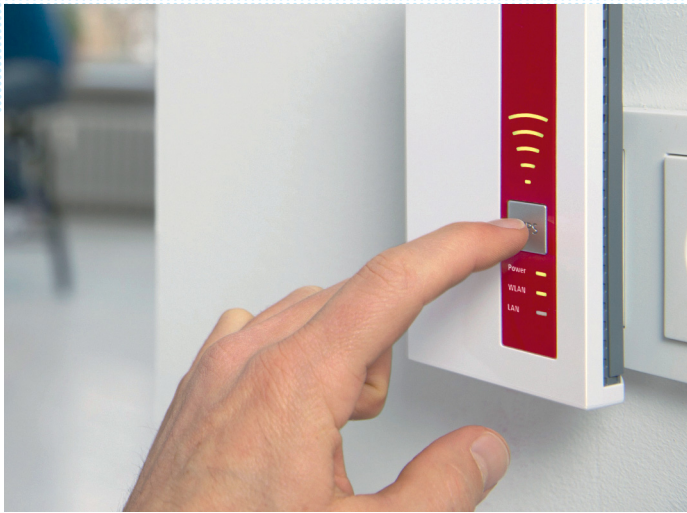
A gombok használatával gyorsan csatlakoztathatjuk a repeatert a router WLAN hálózatához, vagy resetelhetjük a repeatert
