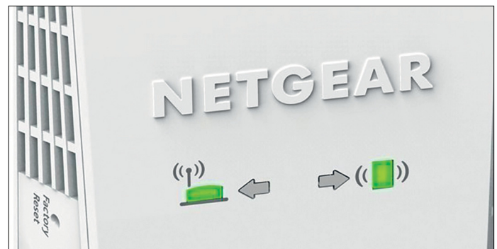
A Netgear EX6400 színes LED-ekkel mutatja a kapcsolat minőségét a router és a kliens készülék között – üzembe helyezéskor csak a legtávolabbi készülék legyen bekapcsolva
