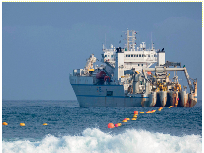
A kábelfektető és -javító hajók egykor különlegességnek számítottak – ma több mint 50 szeli a tengereket, új vezetékeken dolgozva, vagy a régiéket javítva
