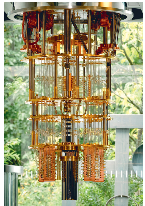
A Google és az IBM által kidolgozott kvantumszámítógépek (jobbra) egy hűtőkamrában dolgoznak, amelyben az abszolút nulla fokot megközelítő hőmérsékletre hűtenek. Áramköreik így szupravezetőkké válnak és qubitekként viselkednek
