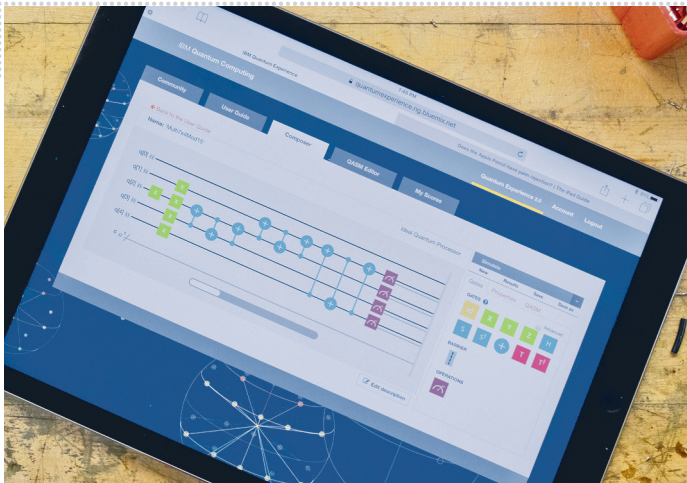
A fenti képen az IBM kvantumchipjének programozása látható. A zöld pontok a qubitek állapotát jelzik, a kék szimbólumok pedig azt, hogy miként vannak összekapcsolva
