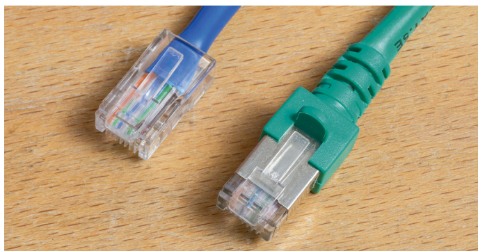
Minél hosszabb a kábel, annál jobb minőségű árnyékolásra van szükség. A jobb oldali kábelnél nemcsak a vastagságon, de a csatlakozón magán is látható az extra árnyékolás
