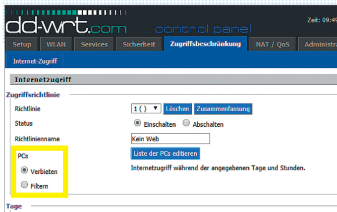
A DD-WRT nyílt forráskódú firmware-rel egész eszközcsoportokat tudunk szétválasztani, és engedélyezni vagy éppen letiltani számunkra a webes hozzáférést
