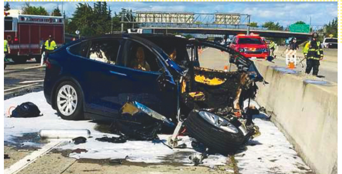
Március 3-án egy Tesla Model X bekapcsolt robotpilótával a sávokat elválasztó betonfalnak ütközött. Az ütközés előtt az autó erőteljesen gyorsított. A Tesla szerint a halálos balesetet az okozta, hogy a sofőr nem figyelt az útra
