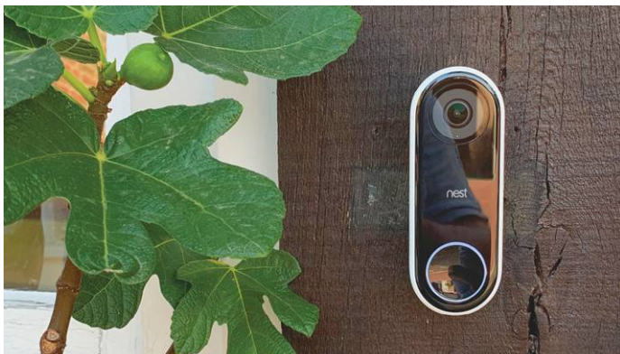
Az okos kapucsengők, például a Nest Hello utólag is beépíthetők a bejárati ajtóba, akár a meglévő kukucskálo helyére is
