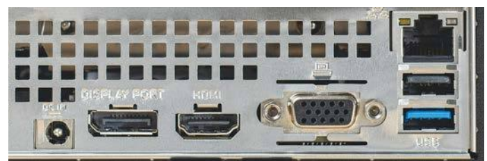
Az ASRock barebone-t felszerelték a legszükségesebb csatlakozókkal: USB-A és USB-C elől (felül), valamint LAN, videokimenetek és USB hátul
