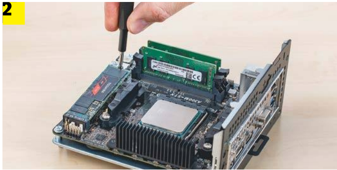
2 A CPU, az SO-DIMM memória és az NVMe-SSD ugyanúgy telepíthető, mint a nagyobb rendszerekben
