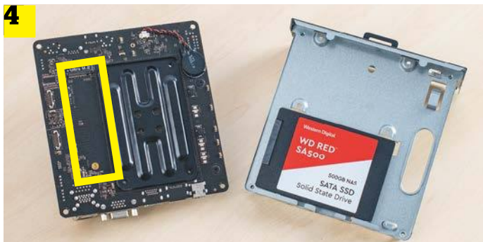
4 Az alaplapp tartólemezeének alján két 2,5" meghajtónak van még hely, az alaplapp hátlapján pedig egy második NVMe SSD-nek
