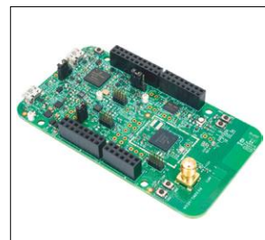
VEGABoard A VEGABoard ARM processzormagokat kombinál RISC-V magokkal
