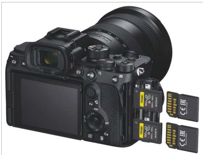
Mindenevő a japán óriástól Kombinált SD-CFexpress Type A aljzatok a Sony a7s III kamerában.
