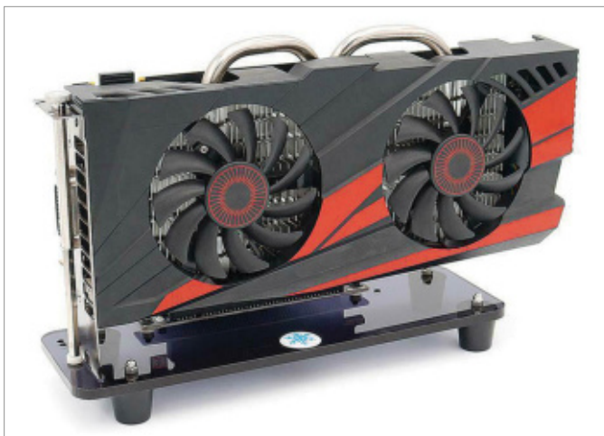
Tisztítsuk le a GPU hűtőt, mert porosan a legjobb megoldások sem érnek túl sokat; a GPU ezért lassul
