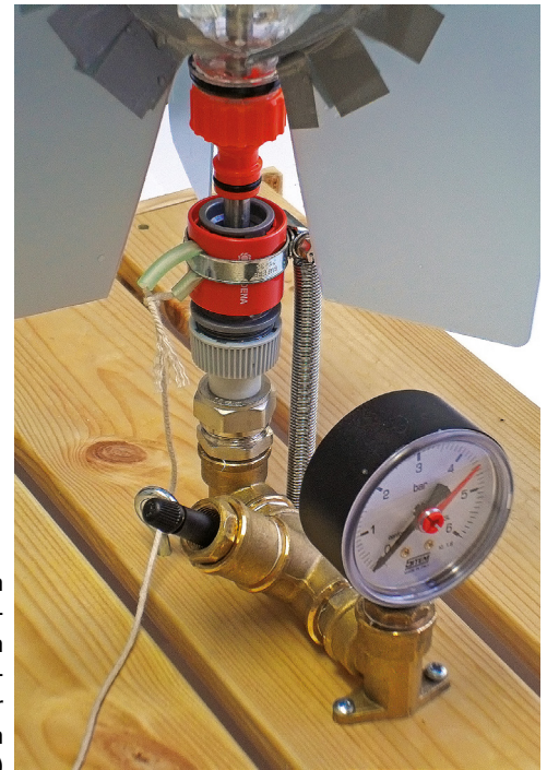
A rakéta és az indítóberendezés (üres rakéta az állványon, a rögzített pozícióból pár cm-re feljebb húzva az indítócsőven)
