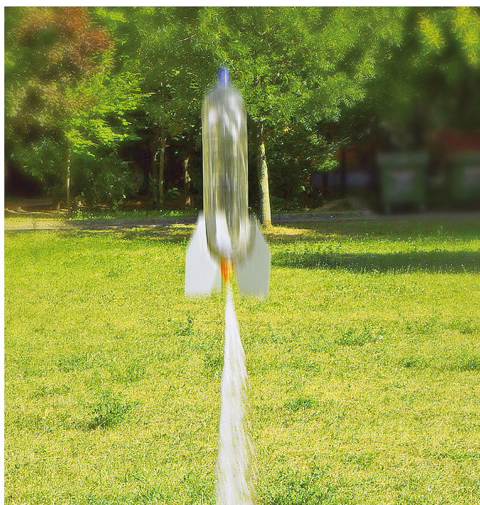
Ha mindent jól csináltunk, a rakéta szépen elstartol a kilövőállásról – és eléri akár a 130 km/h-s sebességet is
