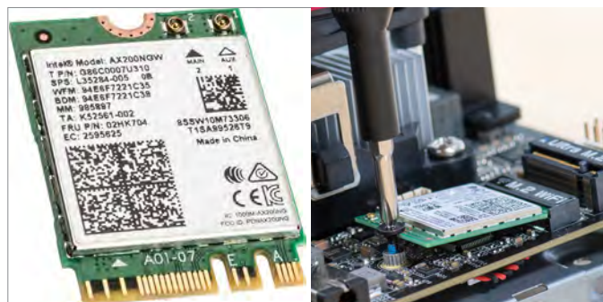
M.2 modul PC-hez, mini PC-hez és noteszgéphez Az Intel AX200 moduljával könnyen frissíthetjük számítógépünk WLAN adapterét, verziótól függően 6-10 000 forintos áron.
