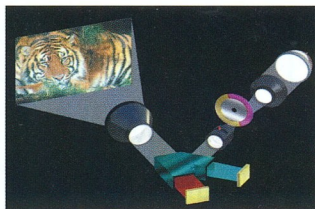
A DLP megvalósítása két DMD chippel
