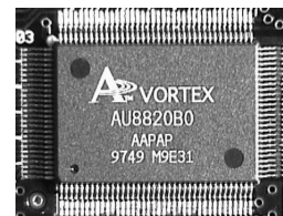
A „Vortex AU8820” Aureal IC-t használja számos „olcsó” 3D-s gyorsítós PCI-os hangkártya
