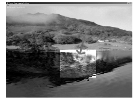
A Matrox Bump-Mapping akcióban: a víz gombnyomásra remegni kezd, aminek a célja a realisabb megjelenítés
